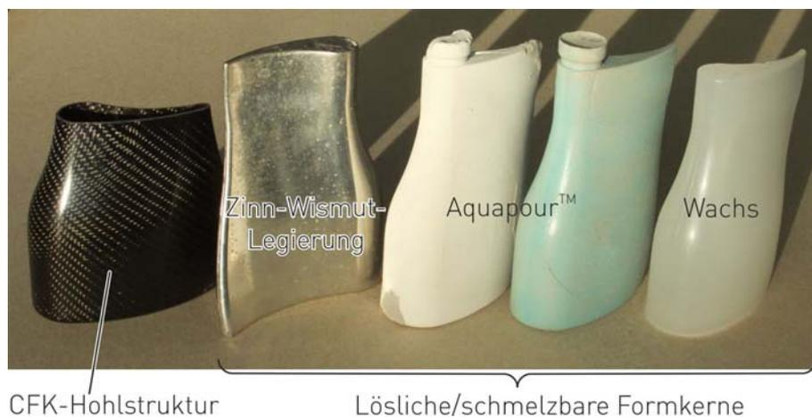
**Bild 8:** Prototypische CFK-Hohlstruktur (links); für die RTM-Fertigung verwendete lösliche und schmelzbare Formkerne (rechts)
