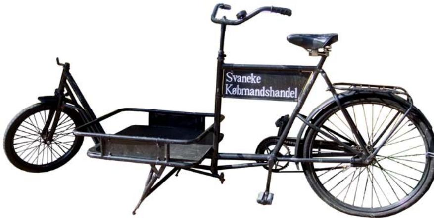
**Bild 1:** In Dänemark entwickelter und im Jahr 1930 eingeführter Transportfahrrad-Typ „Long John“
