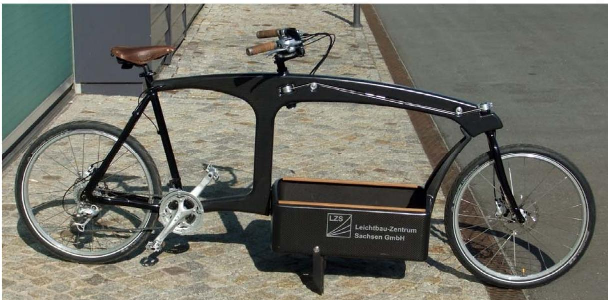
**Bild 9: Prototypisches Leichtbau-Transportfahrrad**
