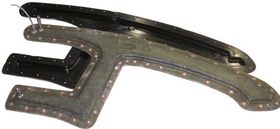
**Bild 7: Formwerkzeug für den CFK-Hauptrahmen**
