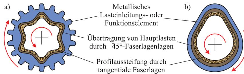
**Abb. 7.6:** Entwurf von Profilverbindungen zur Übertragung hoher Torsionsmomente: a) Faserverbundgerecht verrundetes Sternprofil, b) Kurvenscheibe mit angepasstem Profil
