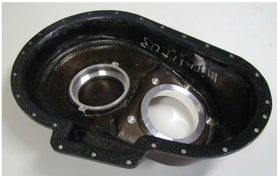
**Abb. 4.9:** Hubschrauber-Getriebegehäusekomponente in CFK-Bauweise mit metallischen Lagersitzen und Insertelementen
