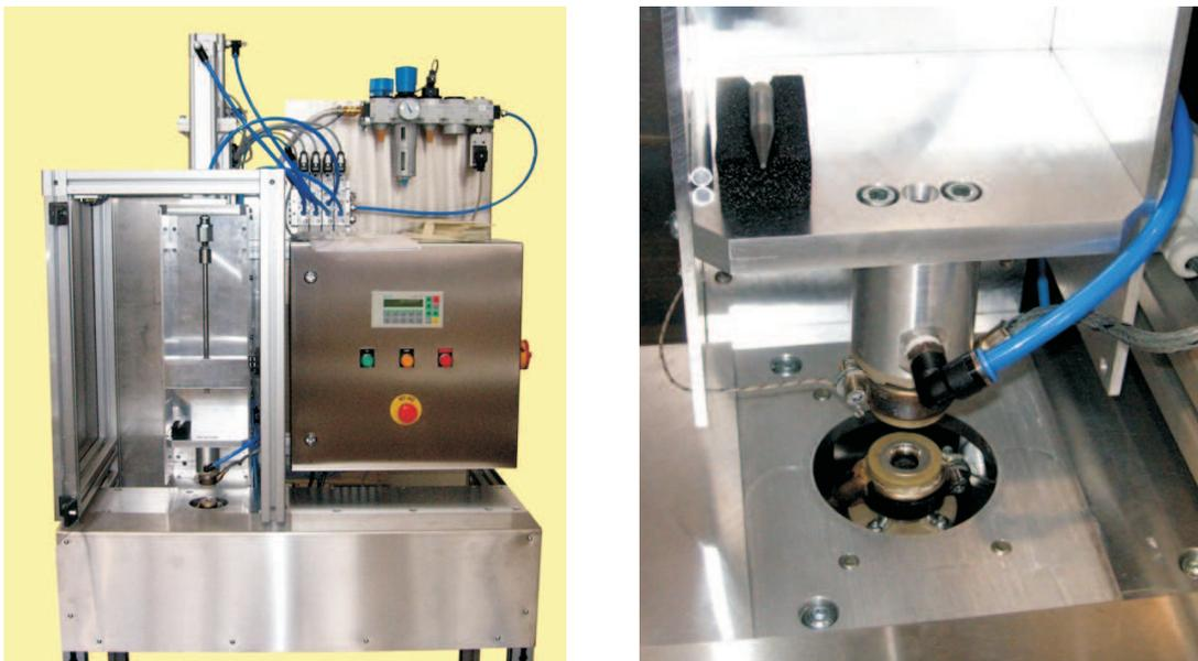
**Abb. 5.10:** Automatisierte EFT-Nietvorrichtung mit pneumatischen Antrieben, geregelter Heizung, Luftkühlung und SPS-Elektronik
