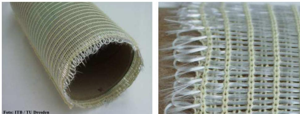
**Abb. 7.13:** Strickschlauch mit UD-Verstärkung (Quelle: ITB, TU Dresden)
