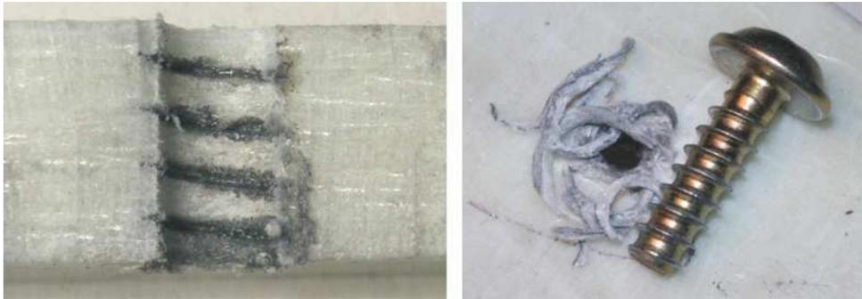
**Abb. 3.2:** Direktverschraubung in textilverstärktem Thermoplast, ausgeformtes Gewinde (links) und abgescherte Gewindegänge nach einem Auszugsversuch (rechts)
