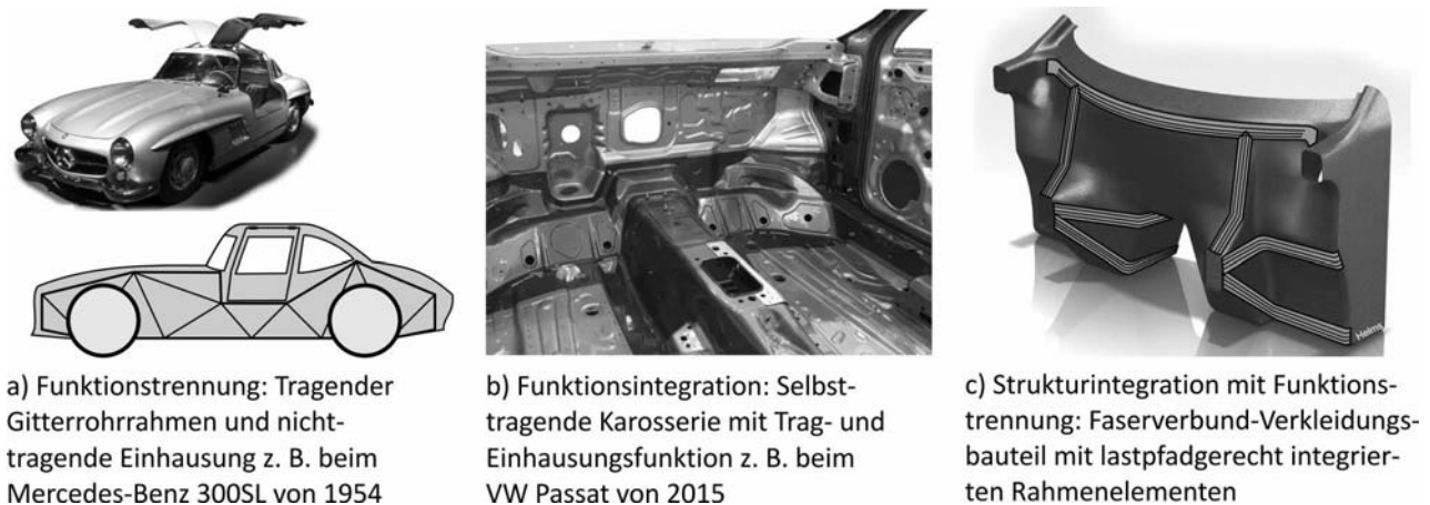
Abbildung 5: Unterschiedliche Strukturintegrationsgrade bei Karosserien
